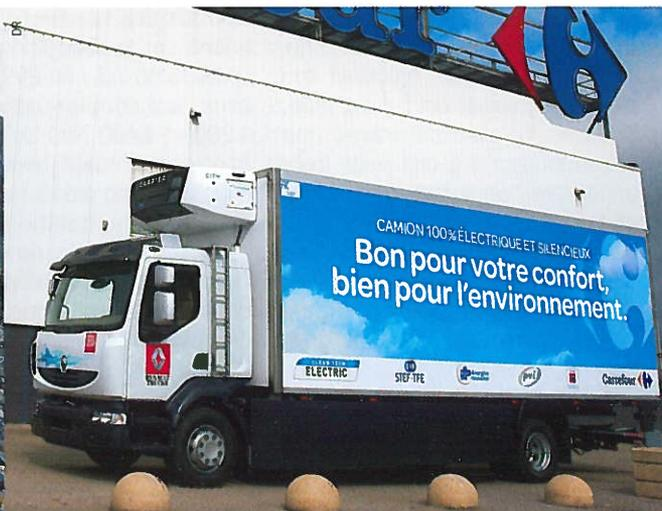
Renault Trucks propose deux motorisations DTI5 240 ch et DTI8 320 ch sur trois modèles de sa gamme Euro 6 compatibles avec le biodiesel. Ici la gamme C. À droite, le Midlum 100% électrique testé par Stef pour le compte de Carrefour.
